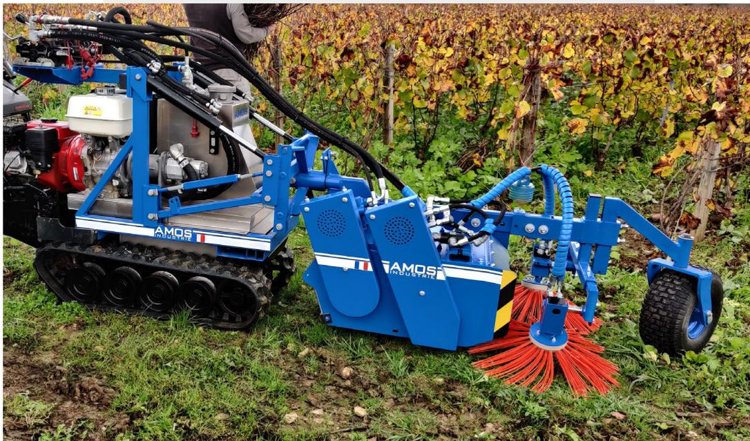
Broyeur BROPOP monté sur centrale HYDROPOP
